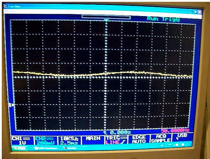
Abbildung 58: Brummen am ADC mit Erdung der Katode
