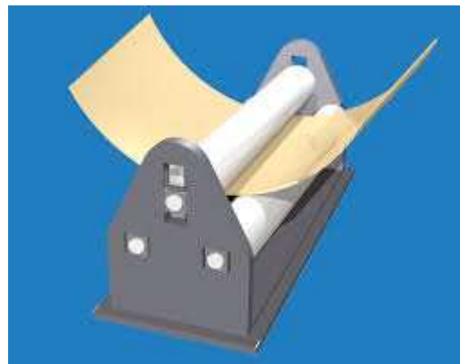
Abbildung 11: Prinzip 3-Walzen-Biegemaschine (Wikipedia)
